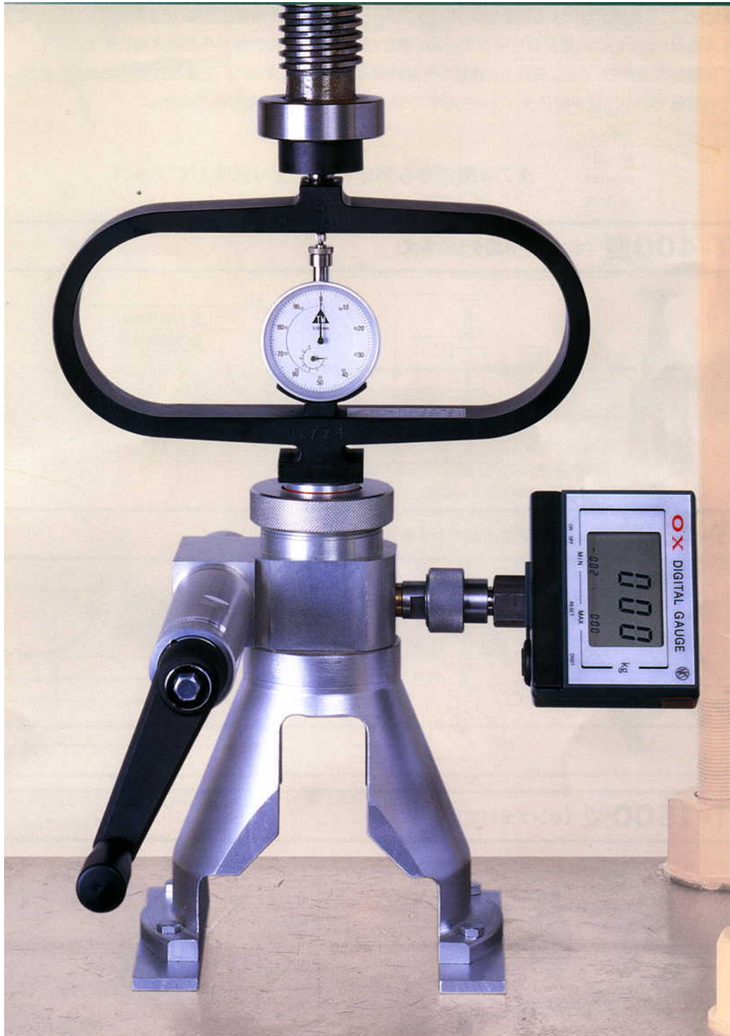
圖 10.6-10 建研式接著力試驗器[52]
